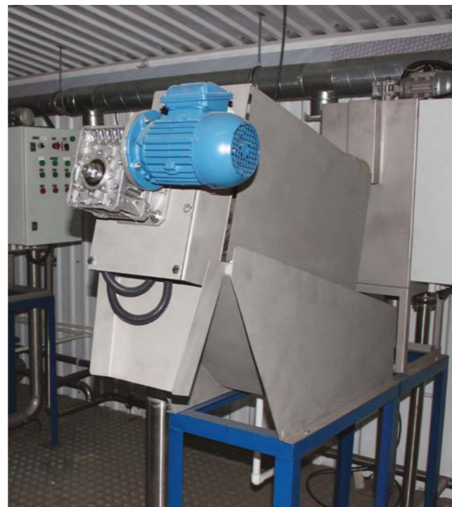
Цех обезвоживания осадка ЦМО® для очистных сооружений автозавода Naval
