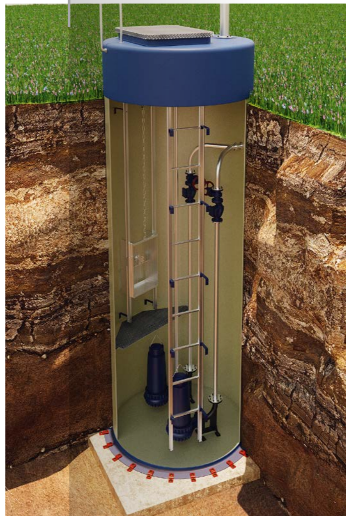
Канализационная насосная станция
